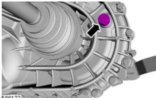
4. 卸下变速器加油口/液位孔塞。
